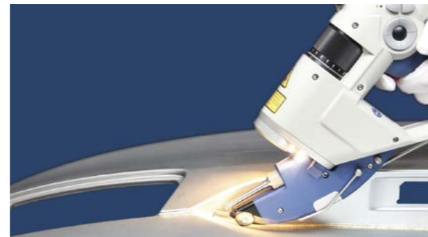
Handgeführter Laser: Der Laser kann nur betätigt werden, wenn das Handteil Kontakt zum Werkstück detektiert. © ALPHA LASER GmbH.
